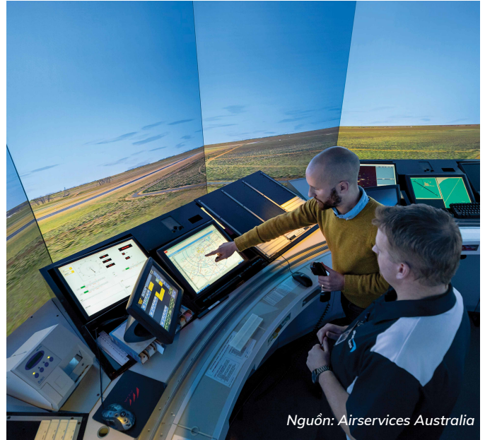
Hình 3 & 4 Nhóm thiết kế kiểm tra từng đường bay với thiết bị mô phỏng chuyến bay (trái) và mô phỏng kiểm soát không lưu (phải)
