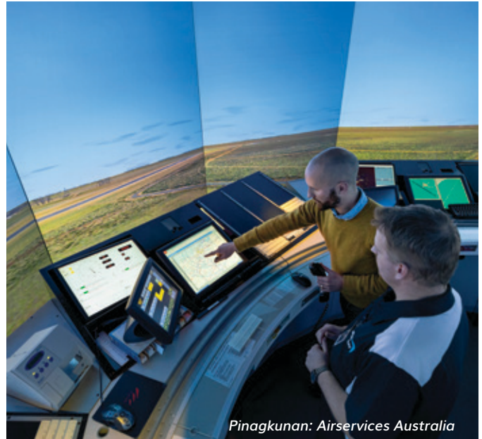
Larawan 3 & 4 Sinusubukan ng pangkat ng disenyo ang bawat flight path sa flight simulator (kaliwa) at air traffic control simulator (kanan)
